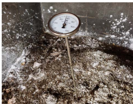
堆肥用温度計(長さ1m)による測定
