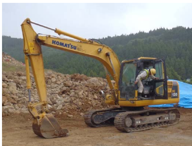
掘削などで使われる油圧ショベル
