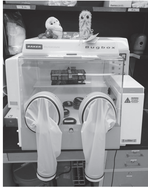
図2 小動物微生物検査室で毎日使う嫌気性チャンパー（Bugbox, Baker Ruskinn）. 上には検査室メンバーがお気に入りの細菌のぬいぐるみが置いてある。
