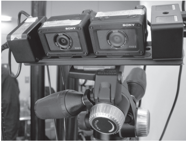
図1 次世代MR技術を用いた遠隔オンラインHands-on実習システムに使用する1台2眼カメラ(4K, 左)と透過型カメラ(右, ホロレンズ)
