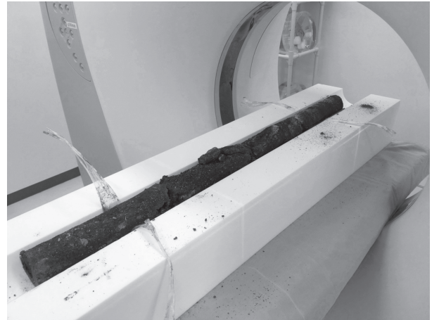
図4 地中断層のボーリングコアのCT撮影
