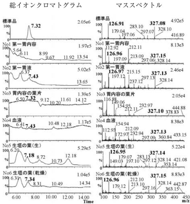
図5 アニサチン定性試験 (SCANモード)
