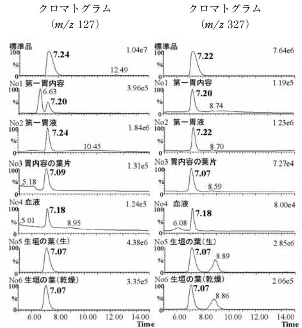
図6 アニサチン定性試験 (SIRモード)
