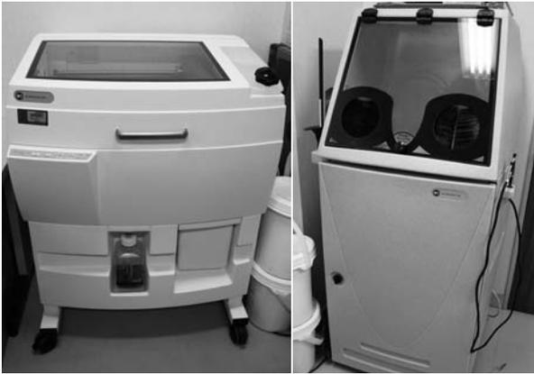
図1 3Dプリンター本体（左）（ZPrinter 310 Plus, Z Corporation, 神奈川）及び造形後の仕上げ作業を行う作業台（右）
